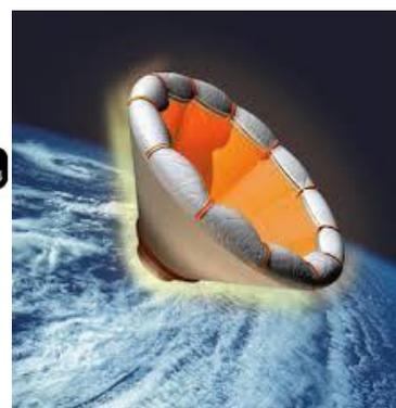
3. ロケットが缶を射出した後、缶に内蔵された減速装置が展開される
